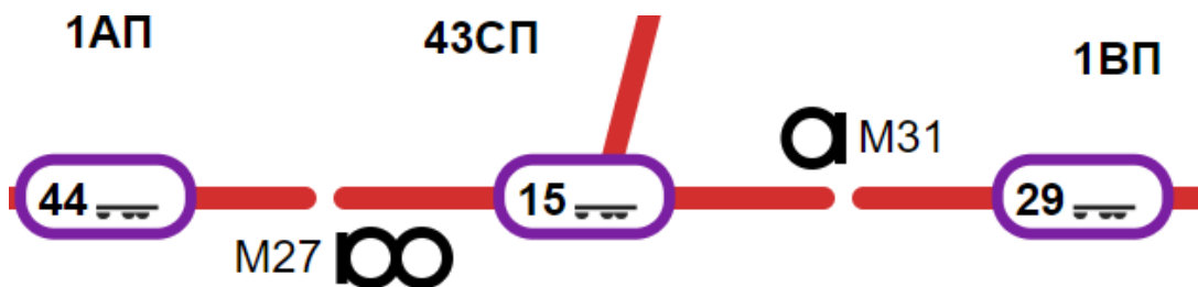
Рисунок 31. Объединение осей, расположенных на соседних блок-участках, в один состав
