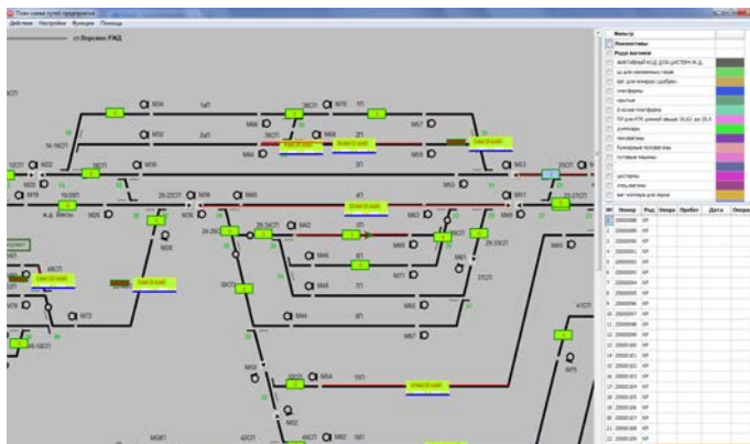
Схематичный план станции
